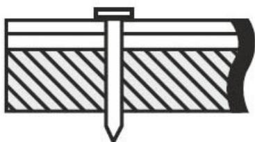
Рис. 3 Пример правильной забивки гвоздей при монтаже продукции.
