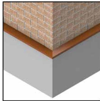
Рис. 22 Устройство внешних углов при помощи угловых элементов.
