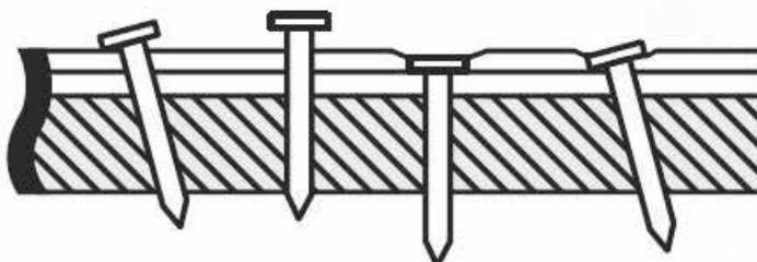
Рис. 4 Пример неправильной забивки гвоздей при монтаже продукции.
