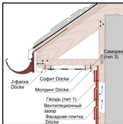
Рис. 33 Примыкание фасадной плитки к карнизному свесу.
