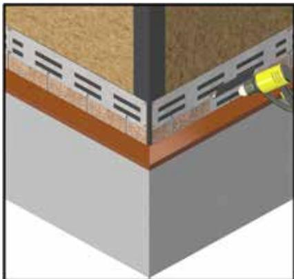
Рис. 15 Прогрев клеевых полос фасадной плитки строительным феном.
