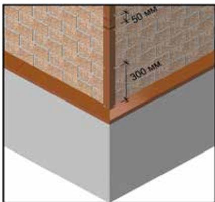
Рис. 16 Устройство внешних углов при помощи металлических уголков.
