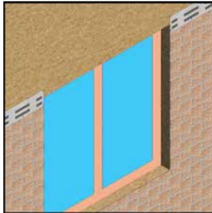
Рис. 26 Монтаж фасадной плитки вокруг оконного проёма.
