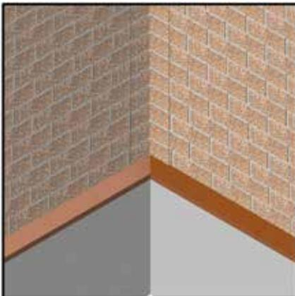
Рис. 24 Устройство внутренних углов при помощи угловых элементов.
