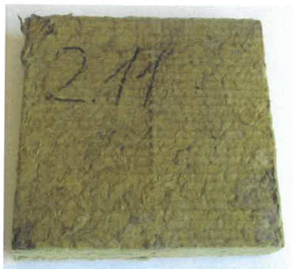
Рис. 4.4 Вид образцов ПП-80 после 100 суток испытания на эмиссию волокон
