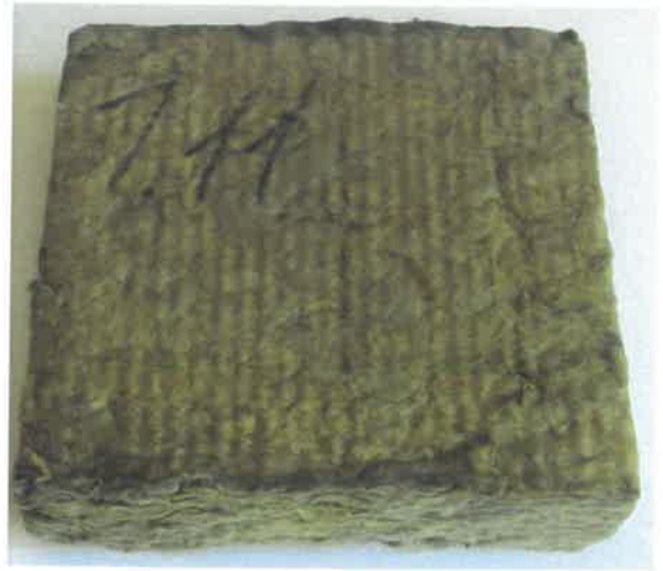
Рис. 4.2 Вид образцов Изолайт Люкс после 100 суток испытаний в установке
