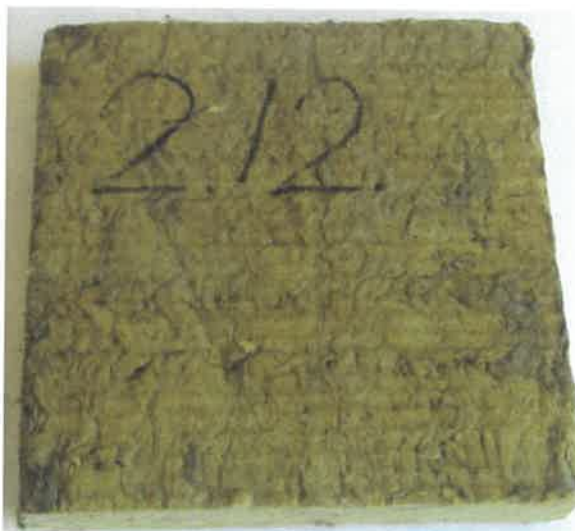
Рис. 4.4 Вид образцов ПП-80 после 100 суток испытания на эмиссию волокон
