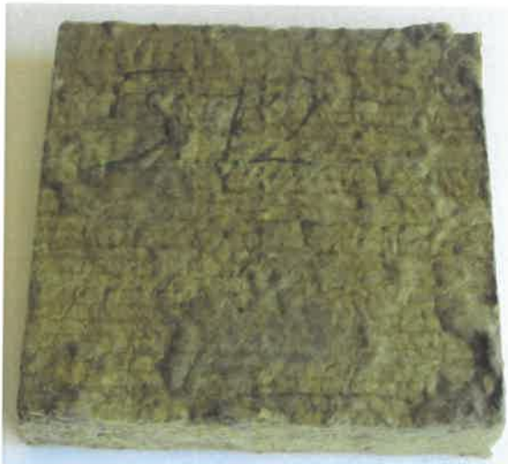
Рис. 4.3 Вид образцов Изовент после 100 суток испытаний в установке
