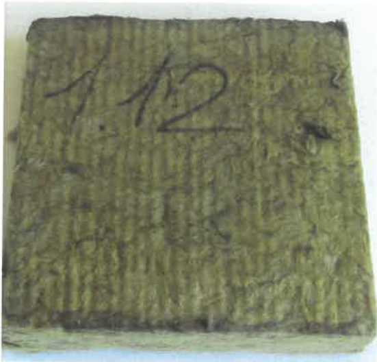
Рис. 4.2 Вид образцов Изолайт Люкс после 100 суток испытаний в установке
