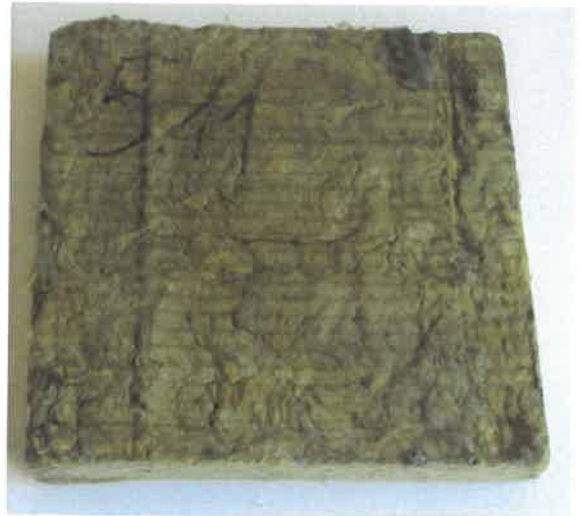
Рис. 4.3 Вид образцов Изовент после 100 суток испытаний в установке
